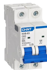
291093 Interruttore magnetotermico 2 moduli 1P+N 32A Curva C 4,5KA 2M mm. 81x36x78
